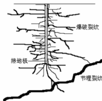
图 9 单根垂直接地极采用深孔爆破接地技术后形成的填充了降阻剂的区域
